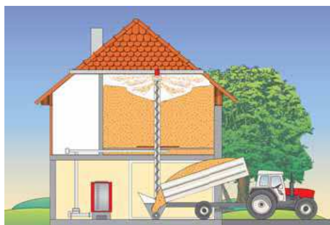
Großes Hackgutlager im 1. Stock mit senkrechter Befüllschnecke und Fallrohr.
