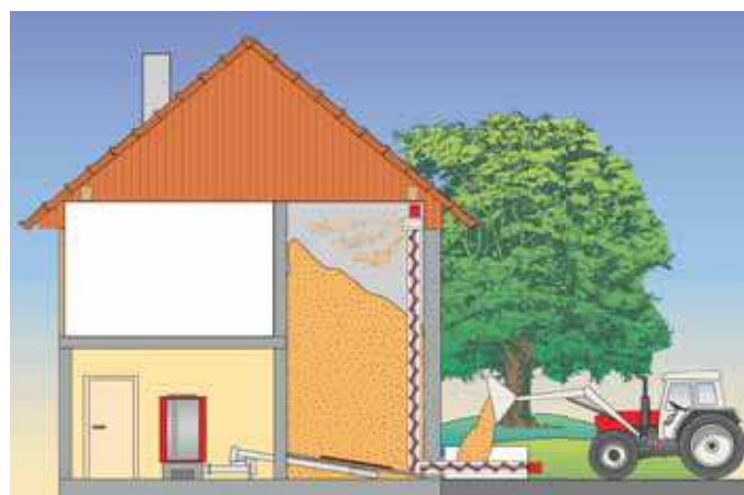
Großes Hackgutlager ebenerdig mit senkrechter Befüllschnecke.
