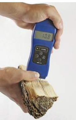
Messung des Wassergehaltes mit einem Schnellbestimmungsgerät
